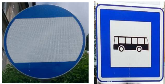
Obrázek 5: Dopravní značka - označnick zastávky IJ 4b (kulatý) a IJ 4a (hranatý)
