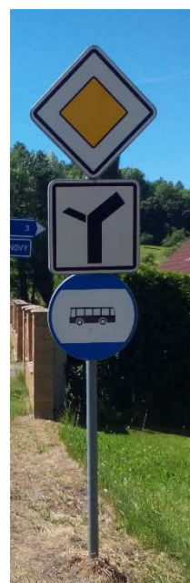
Obrázek 56: Sloupky označníku zleva: "hůl", "áčko", na čekárně, společně s jinými DZ (nevhodný případ zastávky Turnov , Kadeřavec ) a netypový sloupek DPMLJ
