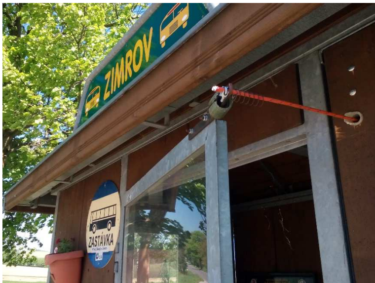
Obrázek 35: Improvizovaný automatický systém zavírání dveří v zastávce Příkrý, Škodějov, Zimrov
